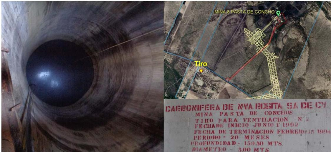
Fotografía No. 9. Tiro vertical de ventilación no. 2
