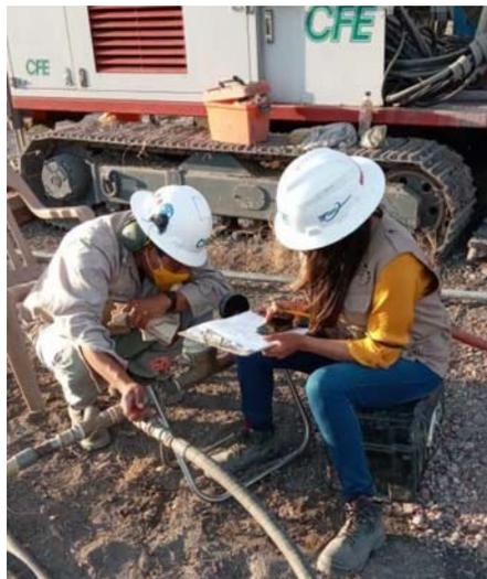
Fotografía No. 20. Ejecución de pruebas de permeabilidad
