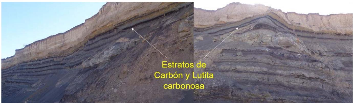
Fotografía No. 15. Estratos de carbón en tajos a cielo abierto
