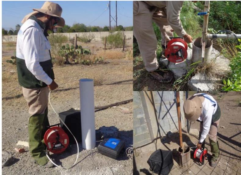
Fotografía No. 18. Monitoreo de la profundidad del agua subterránea
