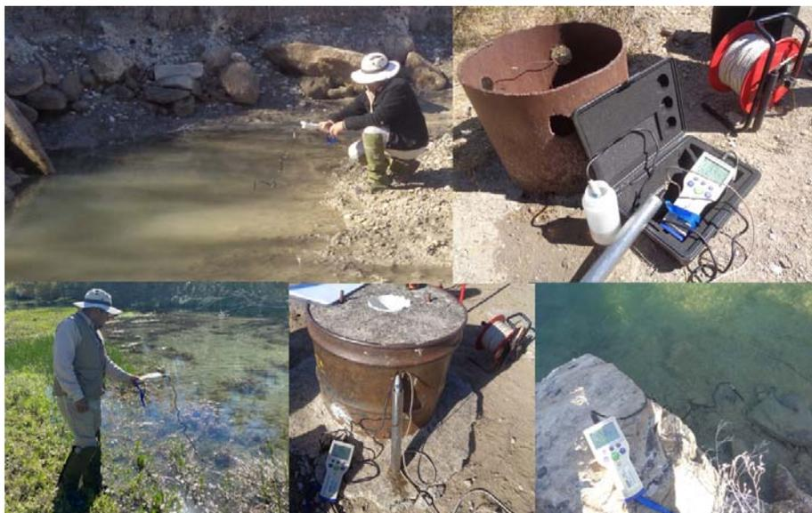
Fotografía No. 6. Monitoreo de la conductividad eléctrica del agua
