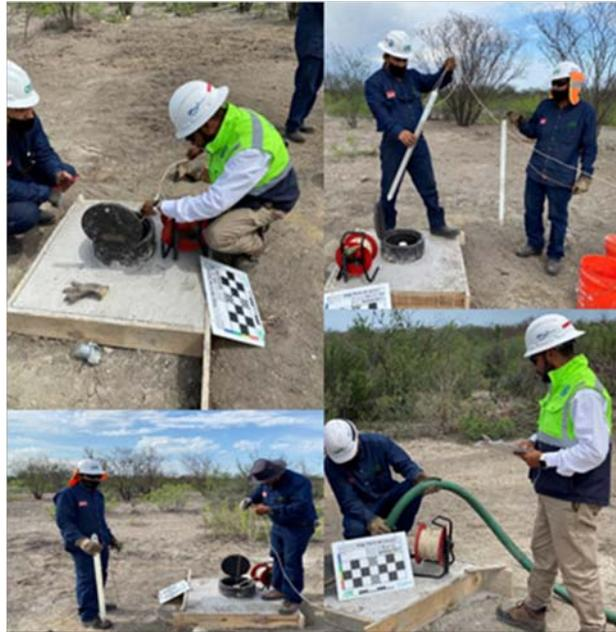
Fotografía No. 22. Desarrollo de pruebas de funcionalidad de piezómetros
