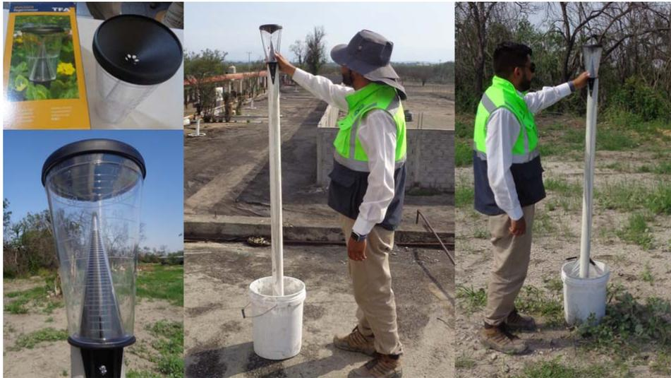
Fotografía No. 2. Instalación de pluviómetros
