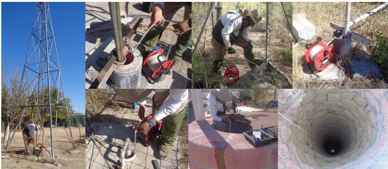
Fotografía No. 4. Monitoreo de la profundidad del agua subterránea
