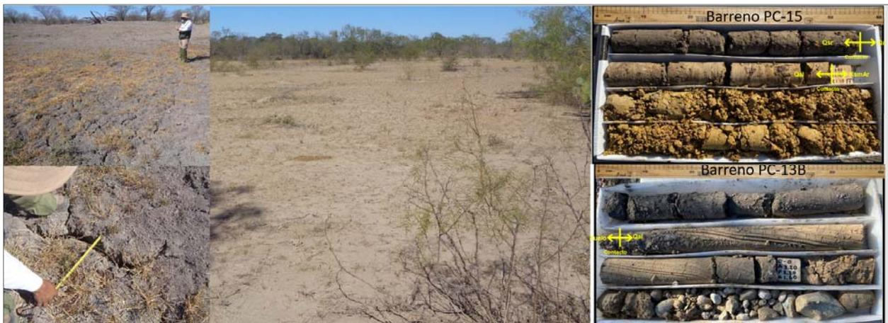
Fotografía No. 11. Materiales granulares de baja permeabilidad
