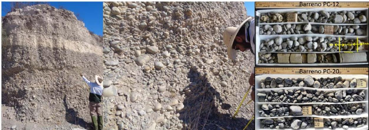
Fotografía No. 12. Materiales granulares permeables
