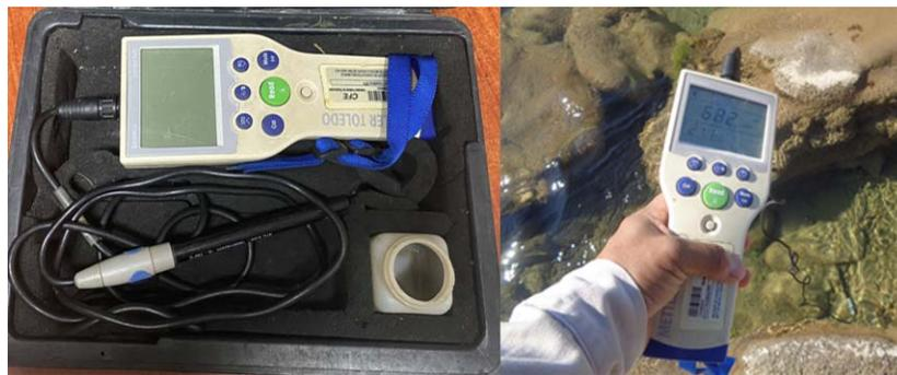
Fotografía No. 5. Conductivímetro portátil
