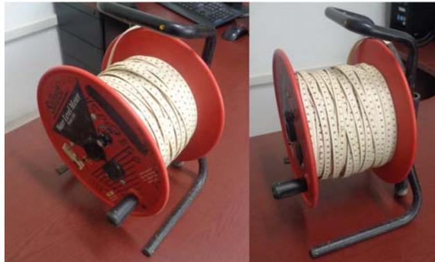
Fotografía No. 3. Equipo de monitoreo (Sonda eléctrica)
