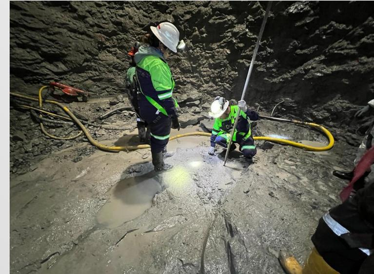
Foto 2. Monitoreo y medición de gases.
