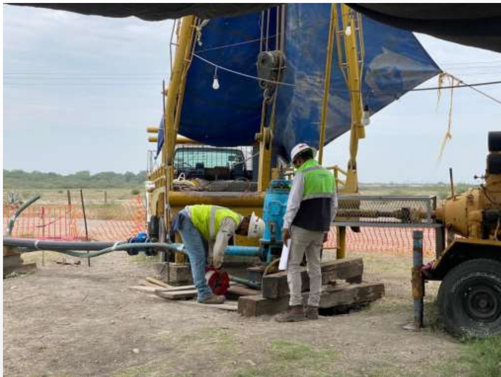
Figura 3: Extracción de agua en el pozo PC-7, con descarga en el cárcamo aireador. Seguimiento de las mediciones de niveles de agua.
