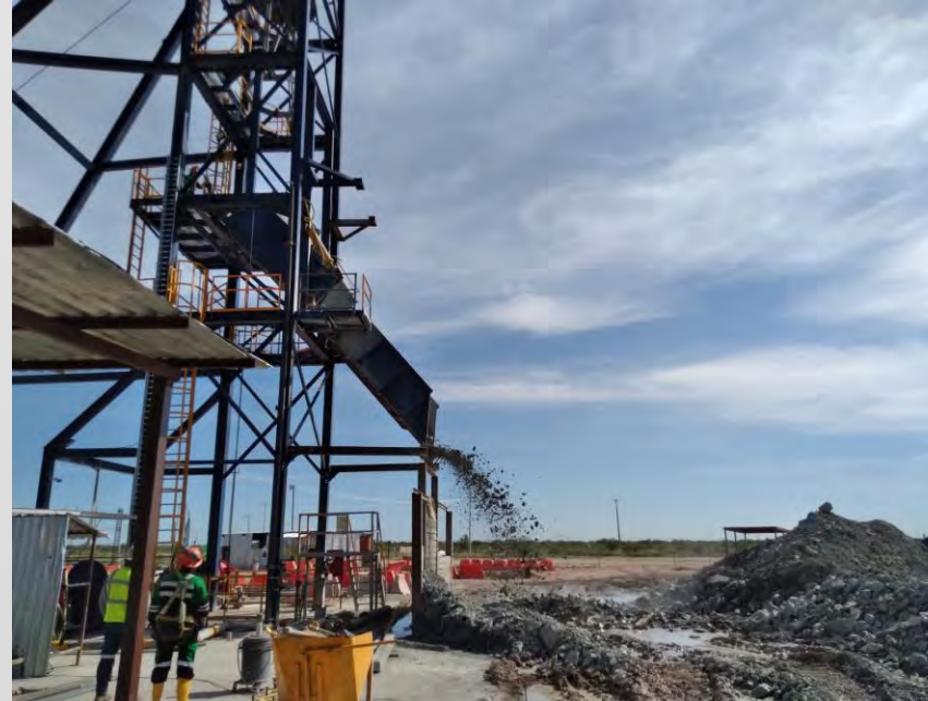
Foto 5. Rezagado del material producto de la voladura.
