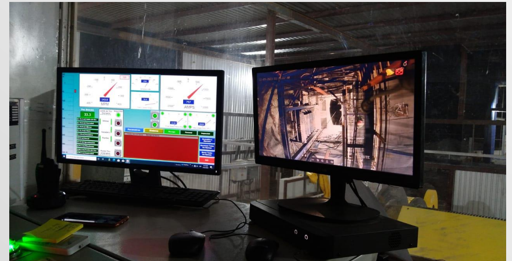
Foto 5. Revisión del controlador del malacate y winches.
