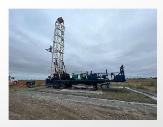
• Figura 1: Trabajos de perforación del pozo **PCE-04**. Continúa la ampliación del pozo, 141 m con un diámetro de 12 1/4", 137.4 m a un diámetro de 19"
