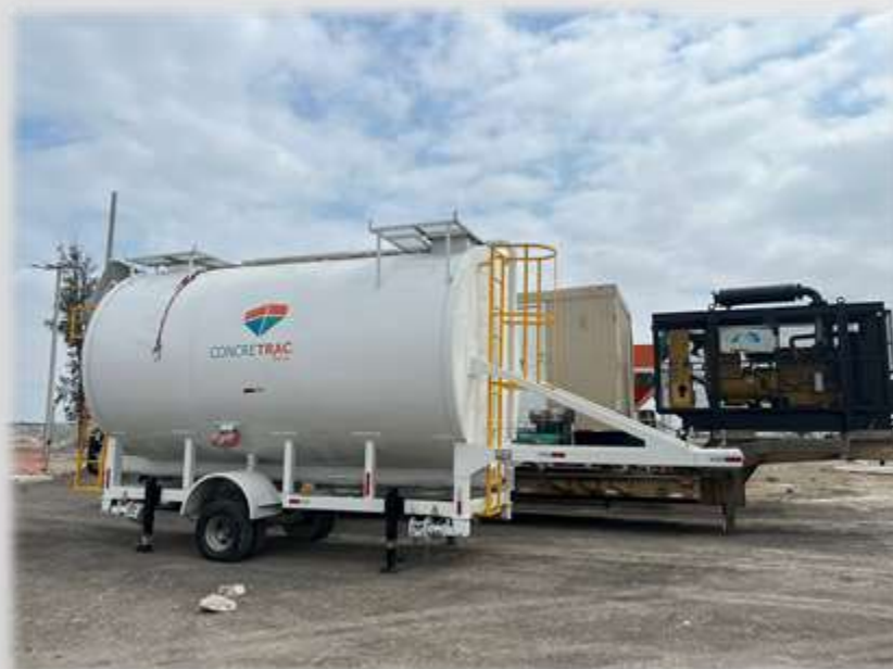
Imagen 2. Silo de almacenaje de 40 t.
