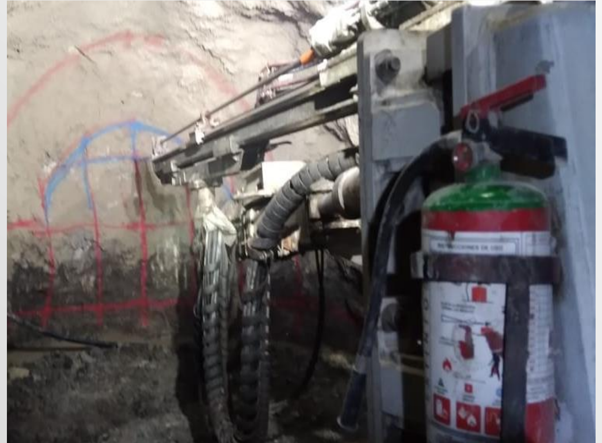
Foto 9. Barrenación de plantilla para voladura.
