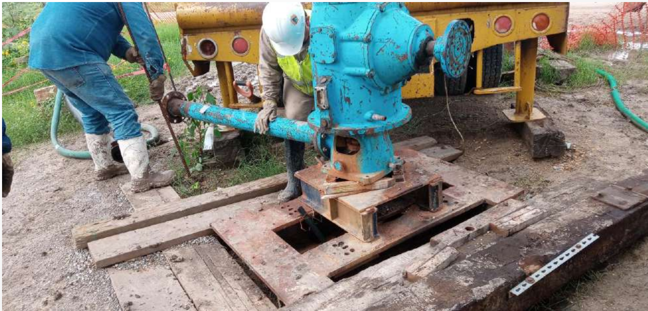
Figura 3: Extracción de agua en el pozo PCV-02 , con descarga en el cárcamo aireador.
