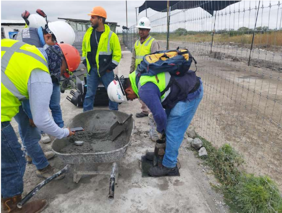
Figura 4: Realización de pruebas al concreto para trabajos de concreto lanzado en la lumbrera PCT-1.
