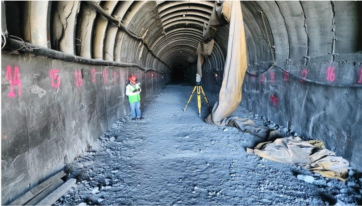
Imagen 6 y 7. Monitoreo de la estabilidad e integridad de los túneles por parte del área de Topografía, Geología e instrumentación.
