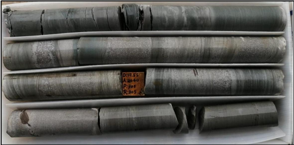
Fotografía 16. Intercalación entre limolita y arenisca, ambas con buen RQD y recuperación.
