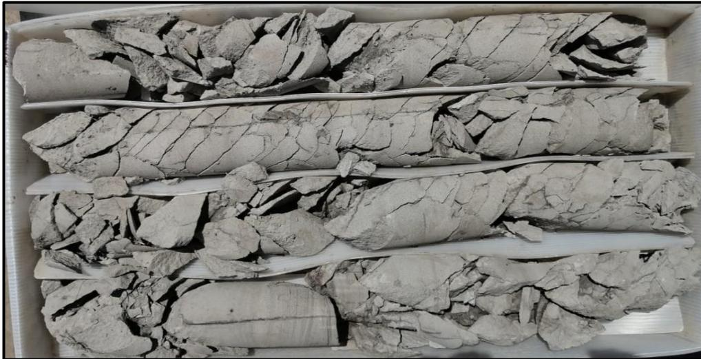
*Fotografía 11. Fracturamiento inducido en arenisca de formación san miguel, exponiendo posibles planos de debilidad fracturamiento.*
