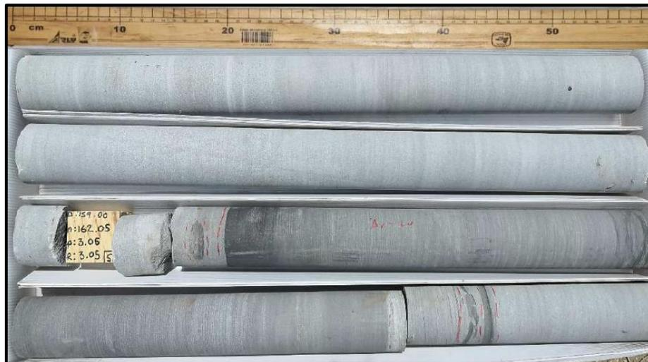
Fotografía 1. Arenisca de la Fm San Miguel, se observa dentro de este un horizonte de arenisca – lutita y lentes de lutita.
