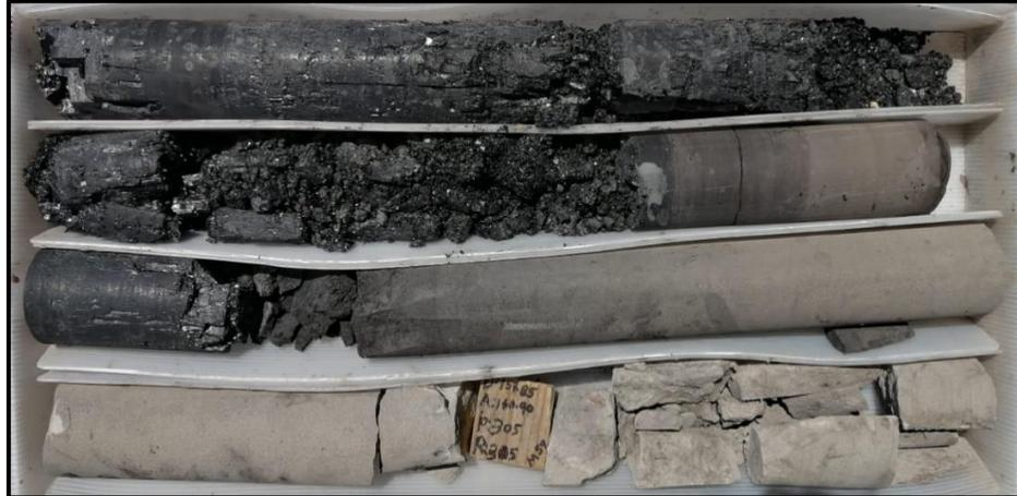
Fotografía 12. Contacto entre formación San Miguel con manto de carbón (formación Olmos), la carga mineral influye en los aspectos físico de la arenisca.
