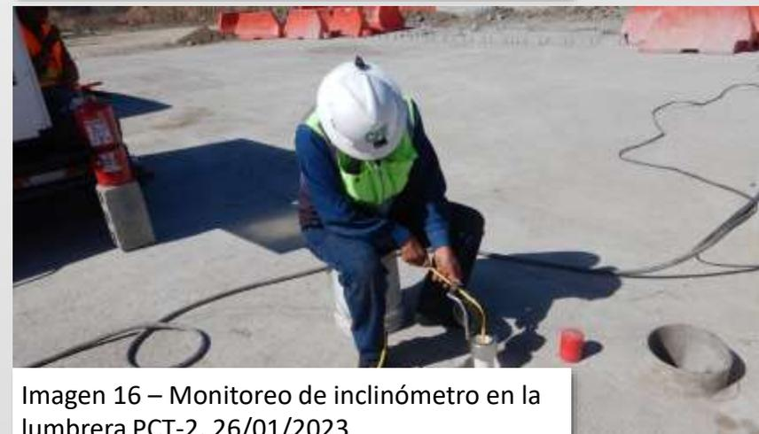
Imagen 16 – Monitoreo de inclinómetro en la lumbrera PCT-2. 26/01/2023
