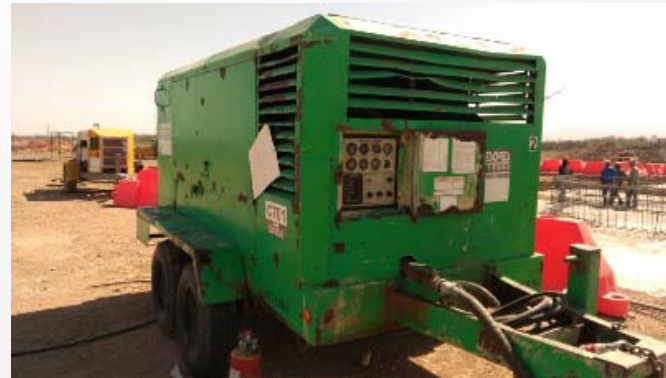
Figura 8: Compresor (parte fundamental para el concreto lanzado).
