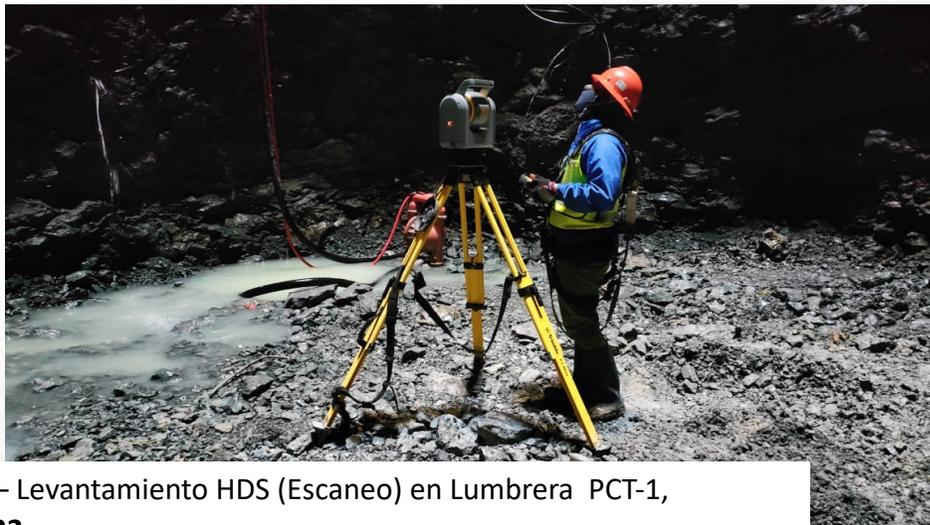
Imagen 6 – Levantamiento HDS (Escaneo) en Lumbreira PCT-1,
