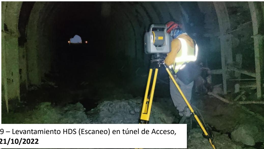
Figura 9 – Levantamiento HDS (Escaneo) en túnel de Acceso, 17,19,21/10/2022
