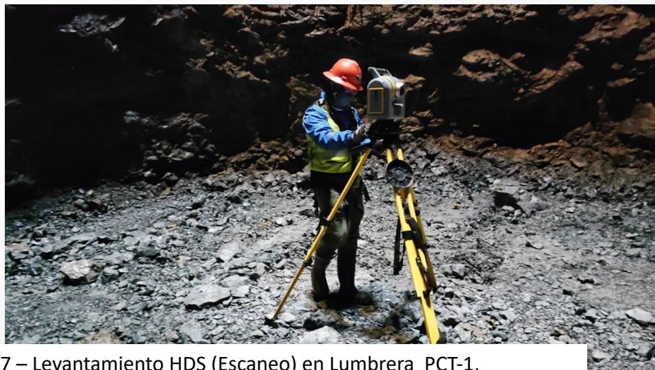
Imagen 7 – Levantamiento HDS (Escaneo) en Lumbreira PCT-1,
