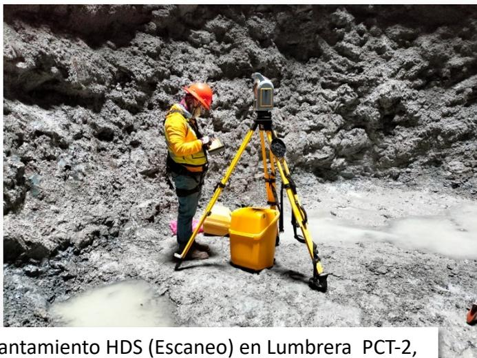
Imagen 15 – Levantamiento HDS (Escaneo) en Lumbreira PCT-2, 19/10/2022
