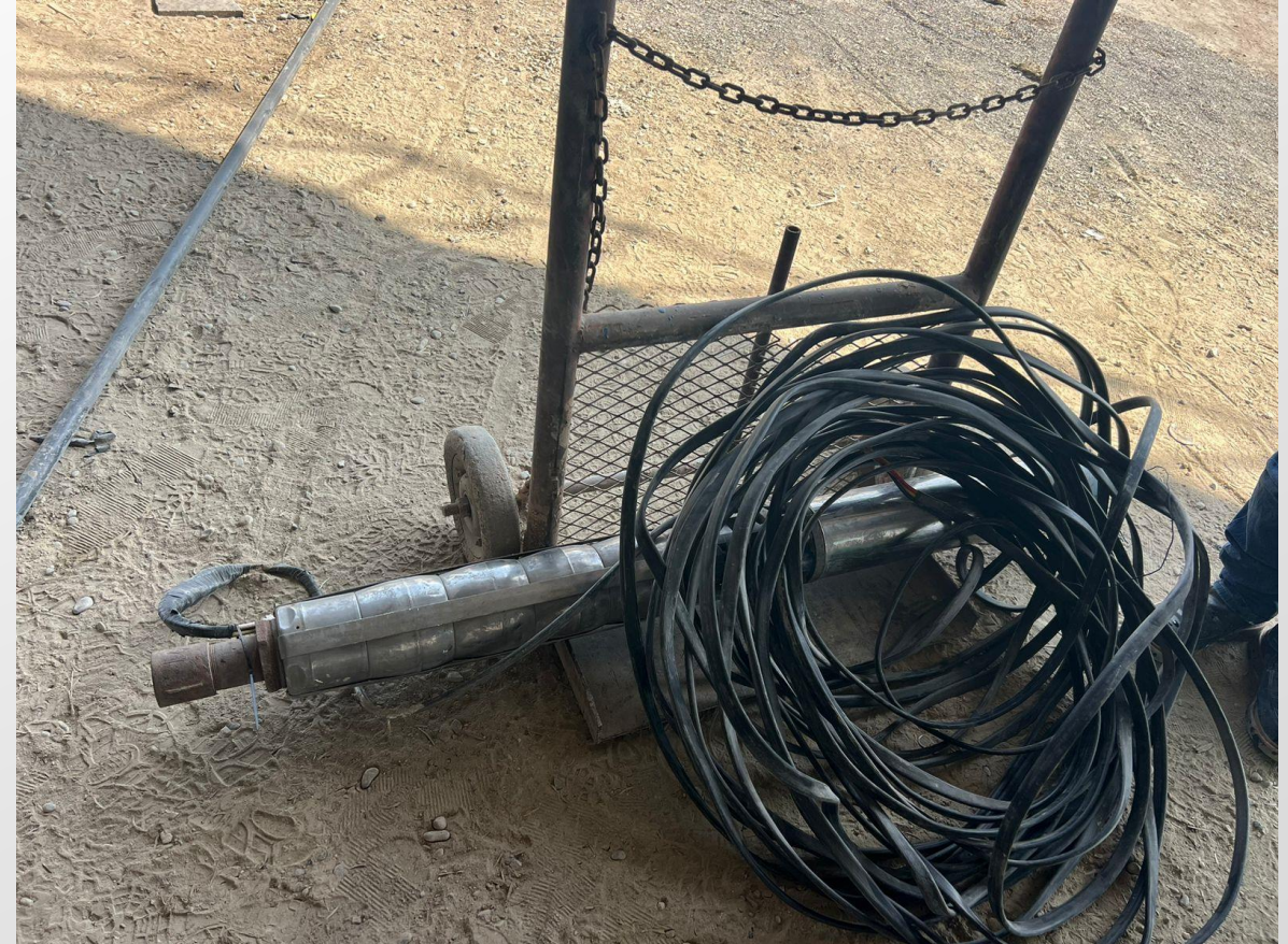
Imagen 7. Equipo de bombeo.
