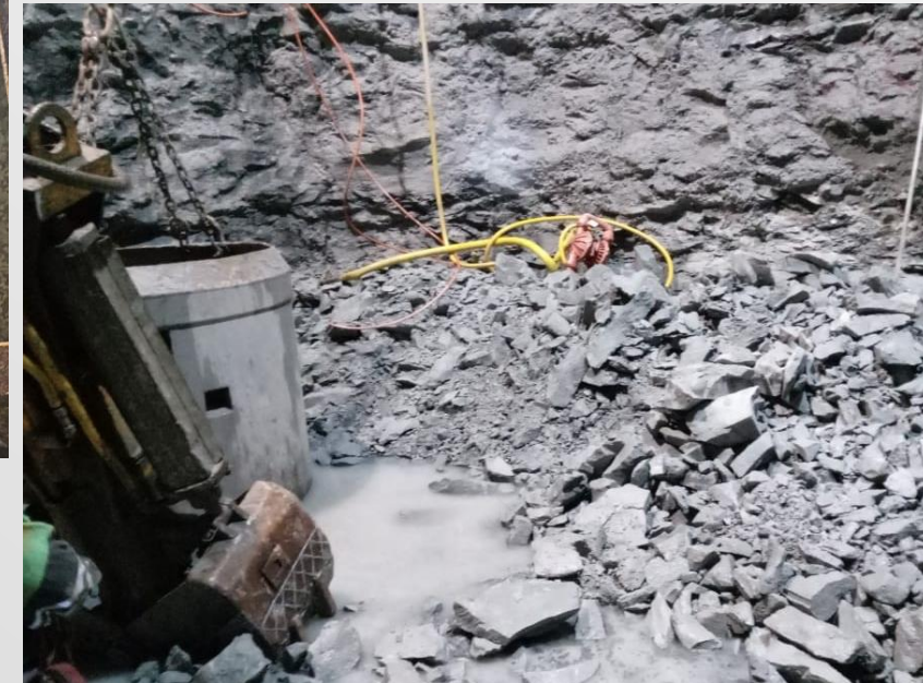
Foto 3. Rezaga del material producto de la voladura.
