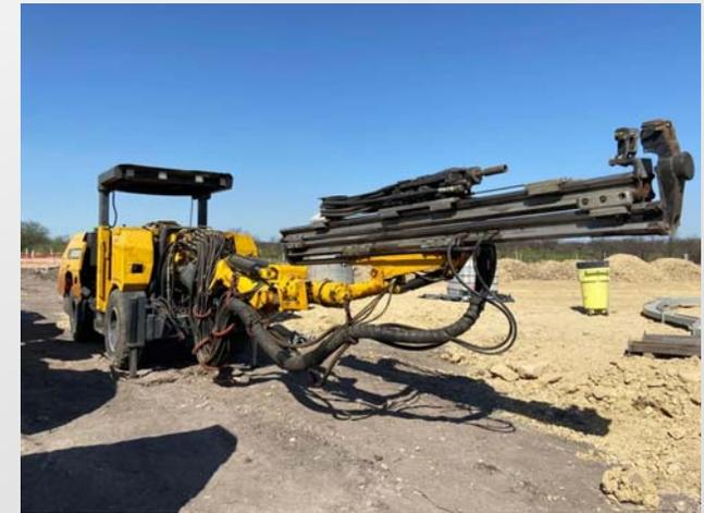
Figura 19: Maquina perforadora Jumbo
