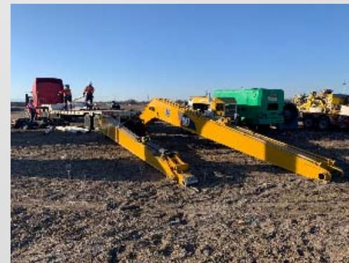
Figura 6: Brazos hidráulicos de excavadora 330.
