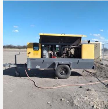
Figura 8: Compresor (parte fundamental para el concreto lanzado).
