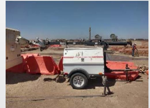
Figura 9: Reflector (trabajos nocturnos).
